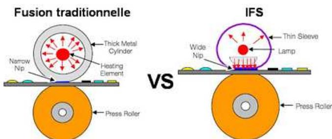
La technologie Instant Fusing de SAMSUNG utilise des lampes à faible consommation pour chauffer le rouleau intérieur de l'imprimante, au lieu d'éléments de chauffage traditionnels plus gourmands en énergie. L'imprimante est ainsi plus écoénergétique et plus efficace.
